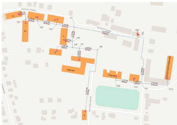
Рис. 2 - Схема теплоснабжения Котельной №1, р.п. Павловка, пл. Школьная, 21
