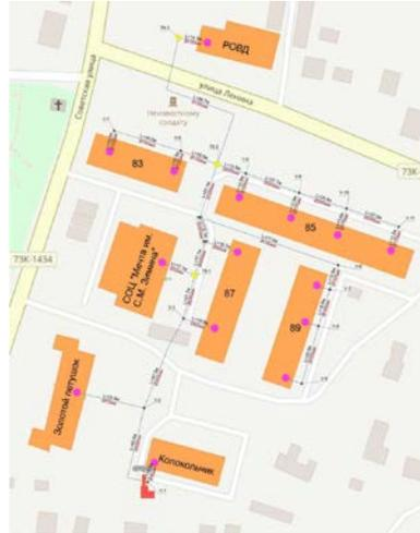
Рис. 4 - Схема теплоснабжения Котельной №5, р.п. Павловка, ул. Ленина, 91А
