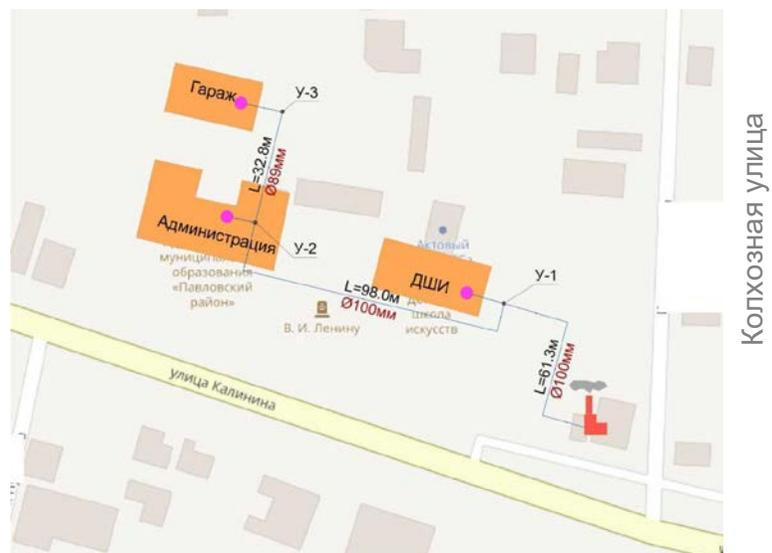
Рис. 3 - Схема теплоснабжения Котельной №3, р.п. Павловка, ул. Калинина, 26А
