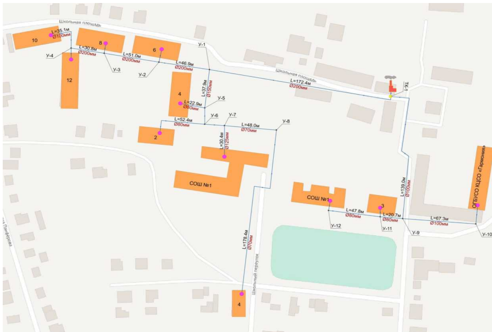
Рис. 2 - Схема теплоснабжения Котельной №1, р.п. Павловка, пл. Школьная, 21
