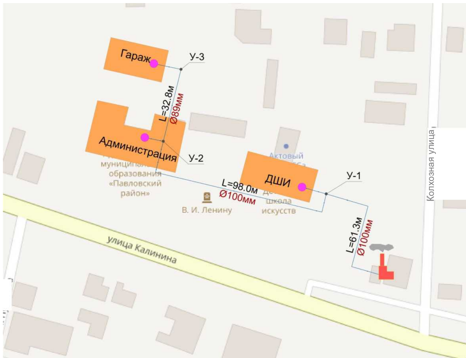
Рис. 3 - Схема теплоснабжения Котельной №3, р.п. Павловка, ул. Калинина, 26А
